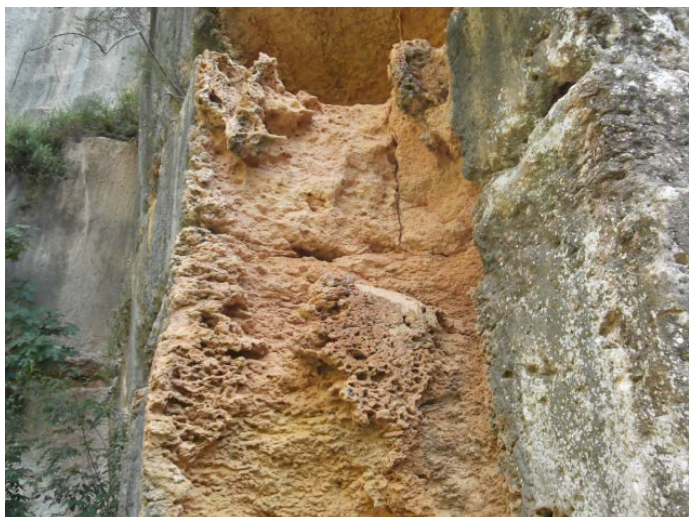
A1 14 – Erosió característica de les calcàries sorrenques terciàries. Pedrera de les coves del Llorito.
