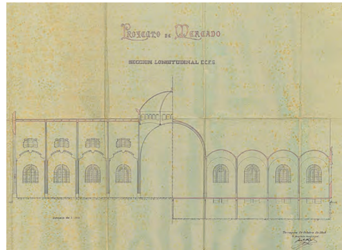
▲ Plànol de la secció longitudinal del primer projecte de Mercat Central, octubre de 1906. AHCT / L'Arxiu
