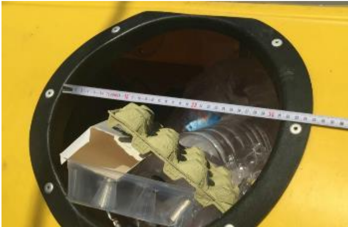
Figura 12. Boca dels contenidors d'envasos de superfície City. Diàmetre = 31 cm.
