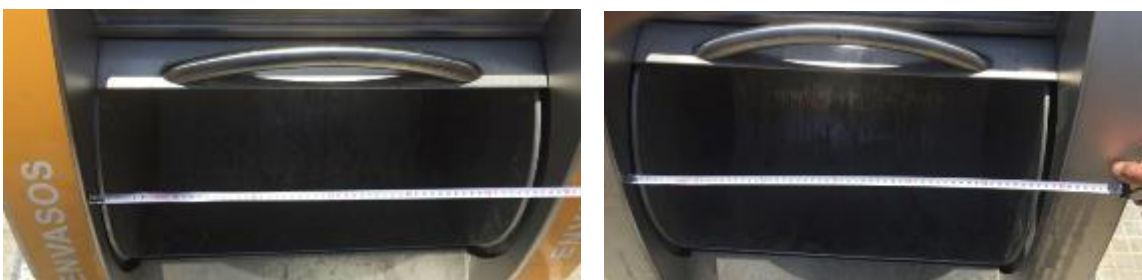
Figura 20. Boca dels contenidors d'Envasos (60 cm) i resta (60 cm) soterrats de càrrega superior VCONSYST - 1 Ganxo, sense tapa reductora.
