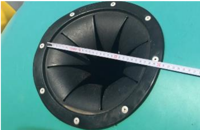
Figura 13. Boca dels contenidors de vidre de superfície City. Diàmetre = 27,5 cm.
