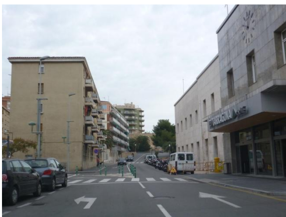
Imatge 25. Plaça Pedrera, pas de vianants davant de l'estació. La visibilitat en passos singulars molt concorreguts hauria d'estar garantida amb mesures físiques que evitin l'estacionament arran de pas.
