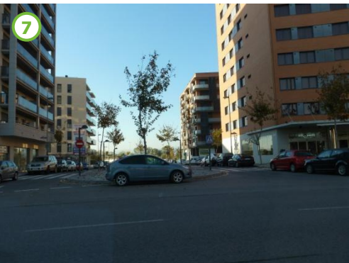
7 Ramal del carrer Josep Maria Terrassa, que segueix la secció de passeig central de l'avinguda President Macià. El sobreample de calçada propicia l'estacionament a dins de la rotonda i en sentit contrari al de circulació. Els vehicles estacionats oculten parcialment el pas de vianants.
