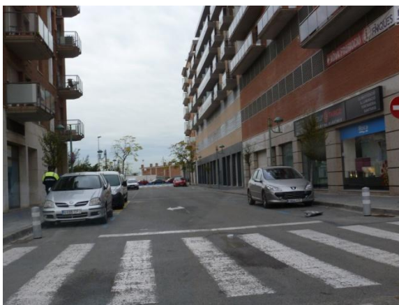
Imatge 37. Carrer Smith amb carrer Pere Martell. Pilones evitant l'aparcament abans de pas.
