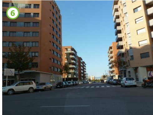
6 Carrer Arquebisbe Pont i Gol, amb un pas de vianants de gran longitud a la sortida de la rotonda, sense separació clara de sentits de circulació i amb vehicles ocultant els vianants.
