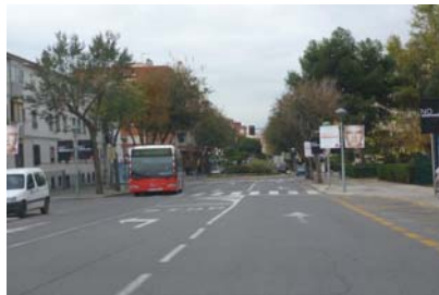
Sentit oest, entre Montblanc i Amposta. El carril de circulació té un sobreample (3,5 m) que pot induir a velocitats excessives. Manca senyalització vertical al pas de vianants (senyal S-13).
