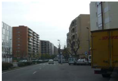
Intersecció amb el carrer Santa Joaquina de Vedruna. Els xamfrans tan amplis amb aparcament no són recomanables des del punt de vista de la seguretat viària.
