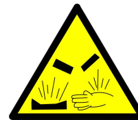
RISC DE CORROSIÓ
