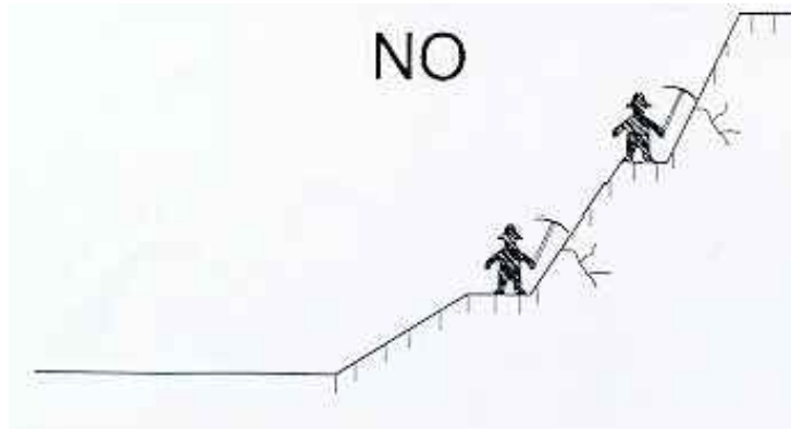
EXCAVACIONS: TREBALLS EN LA MATEIXA VERTICAL
