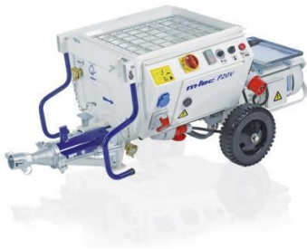
Bomba helicoidal de rotor compacta, p. ej. MTEC P20 400 V. Con una presión máxima de 30 bar y un máximo de 30 m de manguera. Puede requerir un mezclador externo.
