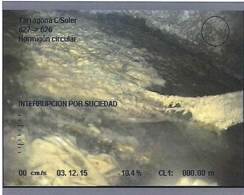
Foto: 9_5A, MPEG #: 021215_1, 00:00:59 1m, INTERRUPCION POR SUCIEDAD
