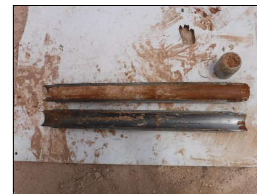
Foto 8: Sondeig S-2, SPT a 4,6 metres.
