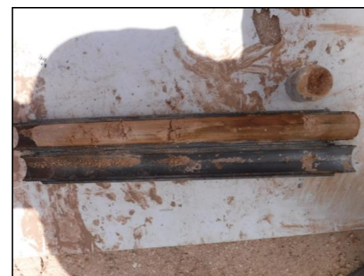
Foto 7: Sondeig S-2, SPT a 1,6 metres.
