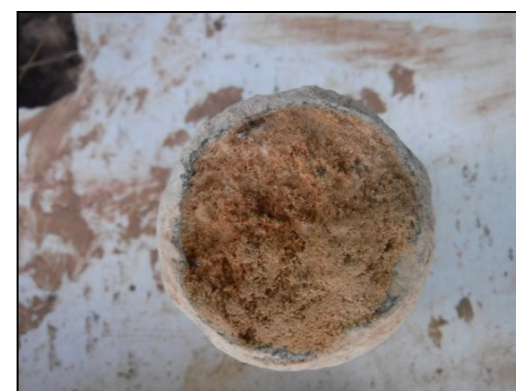
Foto 11: Sondeig S-3, boca SPT a 4,5 metres.
