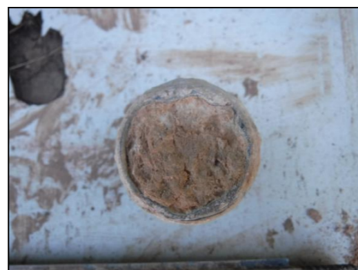
Foto 4: Sondeig S-1, boca SPT a 3,3 metres.
