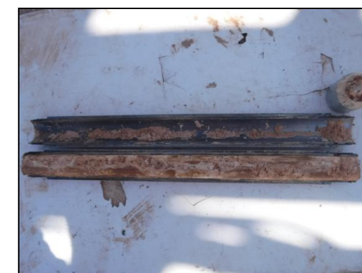
Foto 10: Sondeig S-3, SPT a 2,6 metres.
