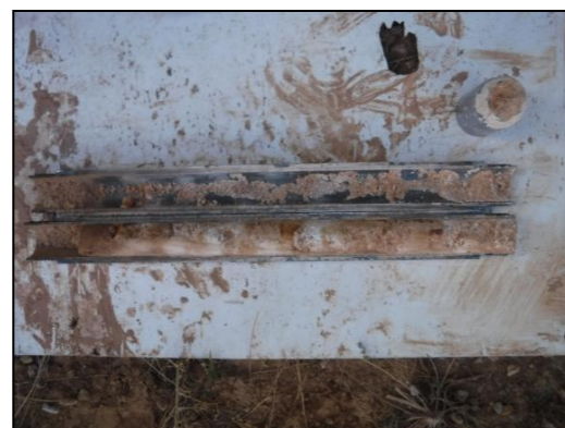
Foto 2: Sondeig S-1, SPT a 1,6 metres.
