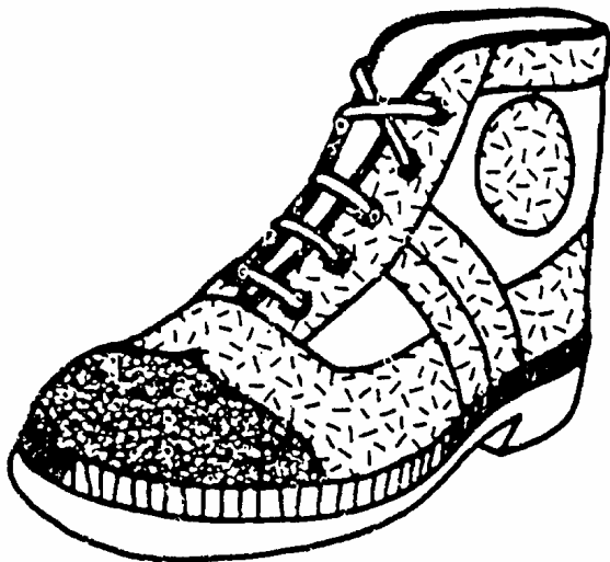
Calzado de Seguridad trabajos eléctricos El calzado de Seguridad será del tipo S1 [SB+A+ E] EN 345 { SB Requerimientos básicos: Protección de la puntera. Resistencia al choque, a la compresión, al desgarrar, a la tracción, a la abrasión, a los hidrocarburos, y a la permeabilidad al vapor de agua. A Calzado antiestático de resistencia eléctrica entre 0.1 Mohm y 1000 Mohm. E Absorción de energía a nivel de talón equivalente a 20 J }
